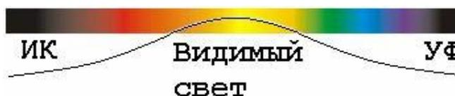
Для излучения используются ИК-светодиоды, работающие в импульсном режиме (ток в импульсе достигает нескольких ампер), для приема – фотодиоды с усилителями. Последние как правило, в аппаратуре закрываются ИК-фильтрами (на практике – красным или дымчатым пластиком) для снижения чувствительности к обычному солнечному или электрическому свету. Как всякий фильтр, он частично задерживает и полезное ИК излучение, поэтому от фильтра также зависит дальность работы ИКДУ
