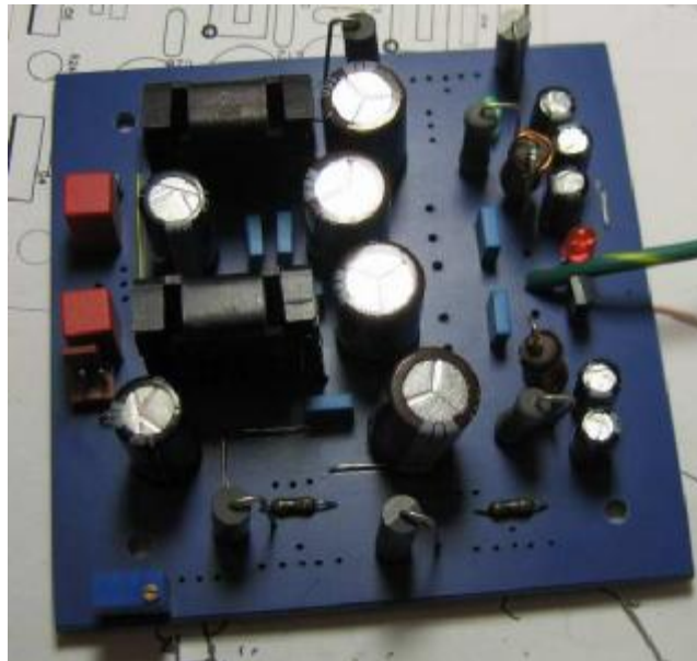
Собранная плата перед установкой в корпус усилителя:
