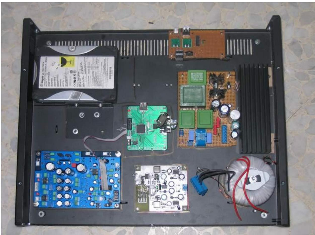
Обратите внимание на количество трансформаторов в блоке питания! Да, тотальная развязка источников питания - залог качественного звука (хотя в данной конструкции и наблюдается некоторый overkill). Большой тороидальный трансформатор – питает винчестер и плату Танго, отдельный маленький трансформатор – питает плату генераторов, другой трансформатор – питает цифровую часть ЦАПа. Еще один трансформатор питает аналоговую часть ЦАПа, и трансформатор чуть побольше – выходную часть ЦАПа.
